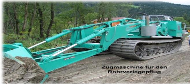
Zugmaschine für den Rohrverlegepflug
